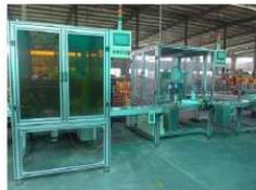
同步器自动检测与装配机器人系统
