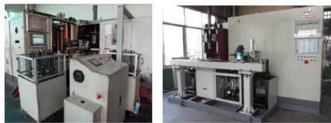
汽车同步器齿圈感应加热压淬机器人及自动化机组（旋转式、直线式）
